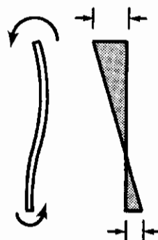
(d) Double curvature column.
